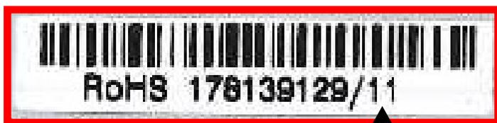
Le chiffre « 11 » à la fin du code-barres lisible par l'homme indique que l'alimentation électrique a été fabriquée en 2011.
